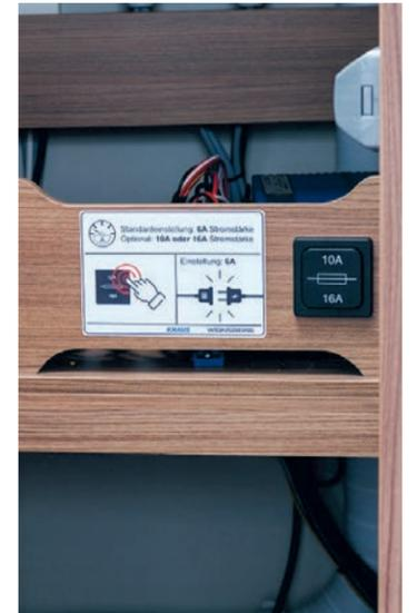
Einige Modelle von Knaus Südwind und Sport sind ab jetzt auch mit E-Power erhältlich. Abhängig vom Stromnetz auf dem Campingplatz schaltet man auf 10 oder 16 Ampere.
