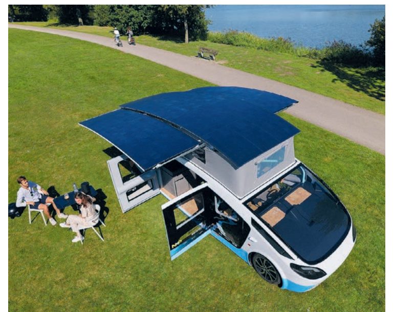
De Stella Vita alcanza una velocidad máxima de 120 kilómetros por hora y en un día soleado puede cubrir una distancia de hasta 730 kilómetros.
